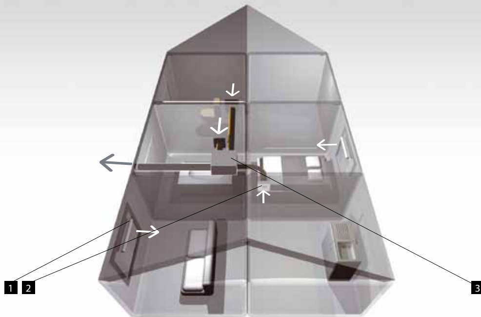
1.Légbevezetők 2. Légelvezetők 3.Központi ventilátor
